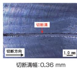
図5 Qスイッチパルスファイバレーザによる難燃性マグネシウム合金AXM620の切断加工結果(板厚:0.5 mm)
