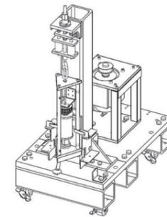
図1 軸受寿命評価試験機
