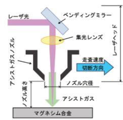
図2 炭酸ガスレーザによる切断加工法
