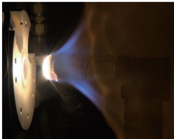
サンプルリターンカプセルに使用される材料の、高エンタルピー下での耐熱特性を確認するためのアーク風洞での実験の様子です。
