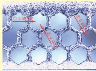
図1 炭酸ガスレーザによる汎用マグネシウム合金AZ31Bの微細加工例(板厚:0.5 mm)
