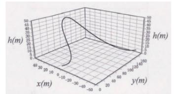
ダイナミック・ソアリングの最適飛行経路
