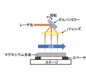
図4 Qスイッチパルスファイバレーザによる切断加工法
