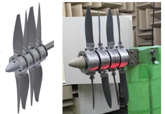
4重反転プロペラ電動推進システム概念図および試作装置
