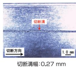
図3 炭酸ガスレーザによる汎用マグネシウム合金AZ31Bの切断加工結果(板厚:0.5 mm)
