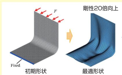
Fig. 1 薄板構造の最適設計の例
