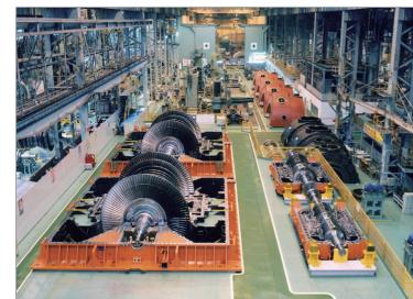
1000MW級事業用火力蒸気タービン
