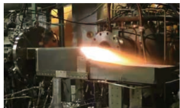
図2 超臨界燃料冷却構造実験
