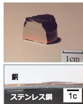
■異種金属板材を組み合わせたクラッドも、爆薬の力を利用して圧着接合で作られています。比較的厚い非鉄金属板とステンレス鋼板等を組み合わせたクラッド材は、一瞬にして作製することができます。
