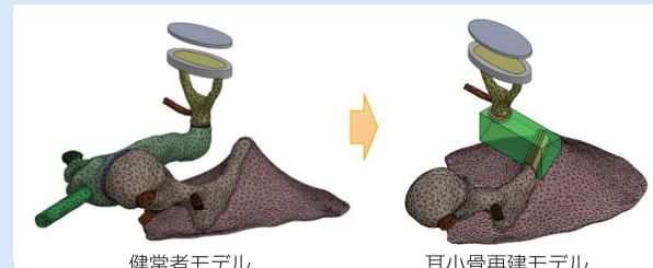
Fig. 2 耳小骨再建手術に用いられる人工代替物の最適設計
