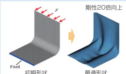
Fig. 1 薄板構造の最適設計の例
